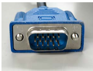
プロジェクター・パソコン接続用ケーブル端子（D-sub 15 ピン）
