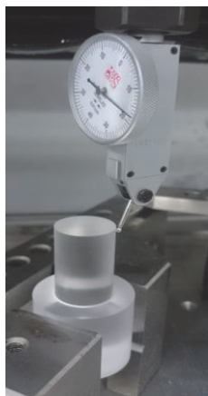
Fig. 1: コーンの寸法精度評価実験風景
