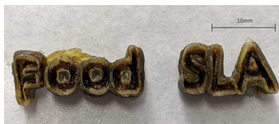
図 1 SLA フード 3D プリンターによる造形例
